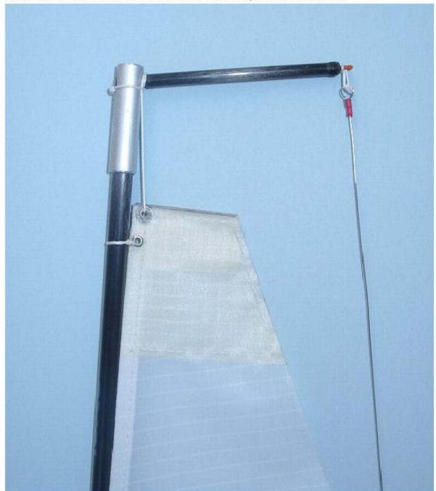
Abbildung 5: Der Kopf des Großsegels mit dem Achterstagbügel
